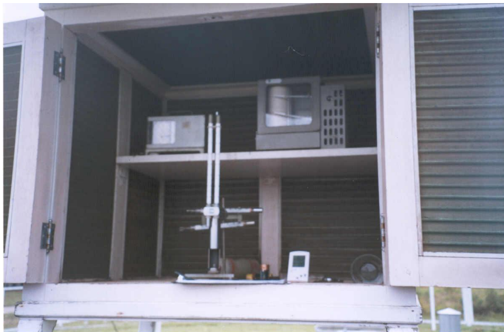
Figura 13 – Foto interna do abrigo meteorológico da Estação Meteorológica de Vargem, SP, pertencente à SABESP, contendo um psicrômetro, termômetros de máxima e mínima, higrotermômetro digital, microbarógrafo e higrotermógrafo. Fonte: CABRAL, E.
